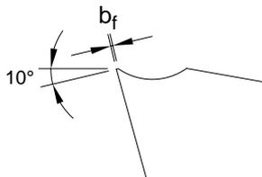
Abb.5-53: Stabilisierte Schneidkante
