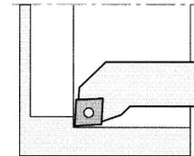
Abb.5-2: rechte Bohrstange
