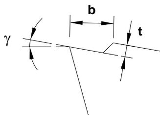
Abb. 5-48: Spanleitstufe
