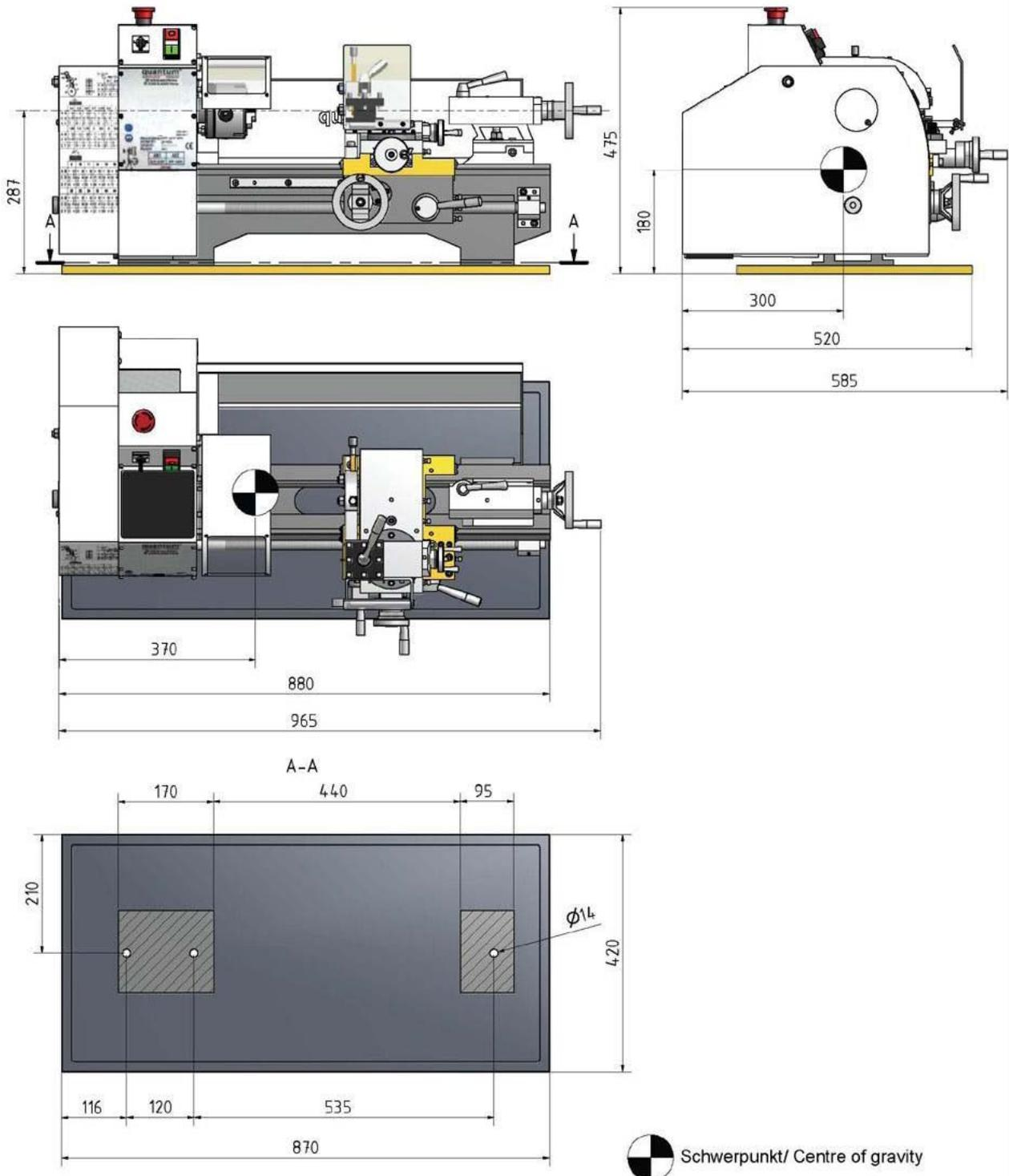
Abb.2-1: Abmessungen, Stellplan D210x400
