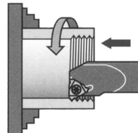
Abb.5-25: innengewinde drehen
