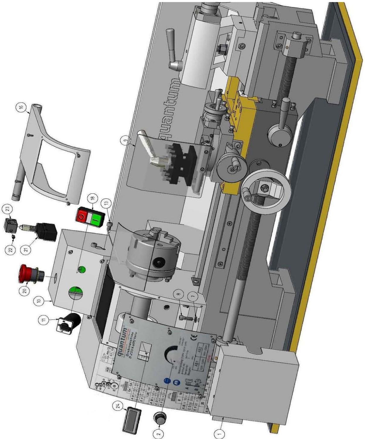
Abb.8-7: Verkleidung Spindelstock - Headstock housing D210x400 Vario, D250x550 Vario
