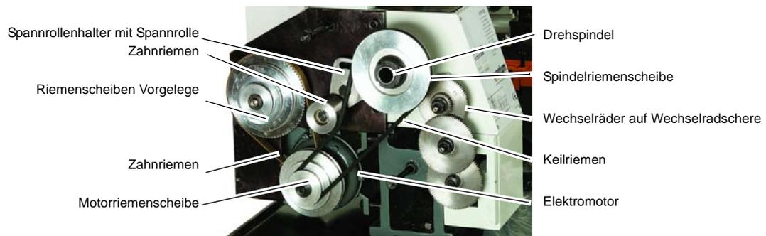
Abb.4-5: Getriebe D 210 x 400
