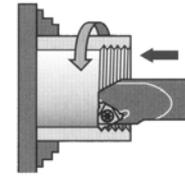
Abb.5-9: Bohrstangen zum Gewindedrehen
