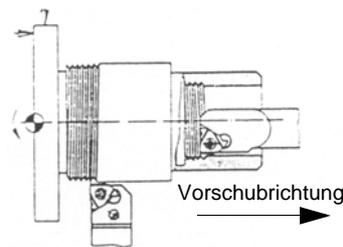
Abb.5-29: Linksgewinde bei Rechtslauf der Maschinenspindel
