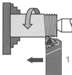
Abb.5-24: Aussengewinde drehen
