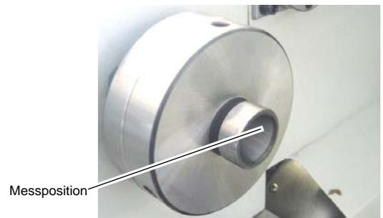
Abb.3-1: Spannzangenfutter 344 1305 ohne Überwurfmutter dargestellt.
