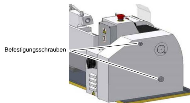
Abb.4-6: Schutzabdeckung Spindelstock
