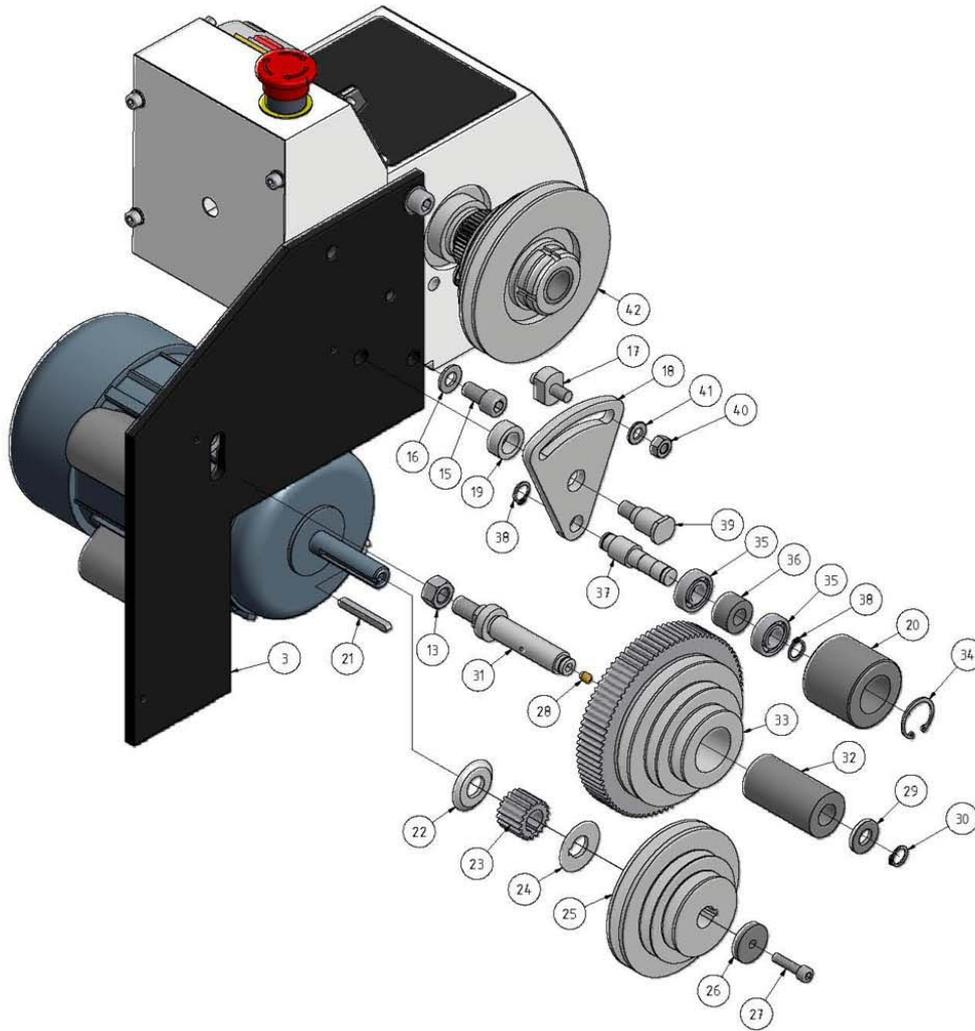
Abb.8-11: Antrieb - Drive D210, D250
