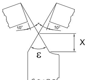
Abb.5-55: Anschliff zum Gewindedrehen
