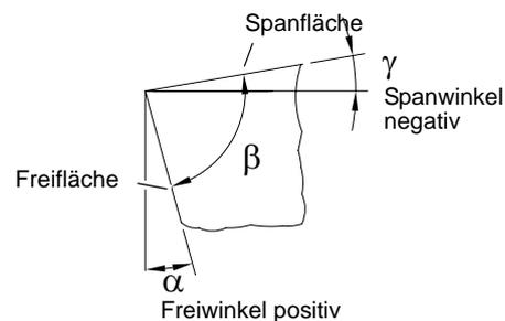
Abb.5-47: Schnitt A - A, negative Schneide
