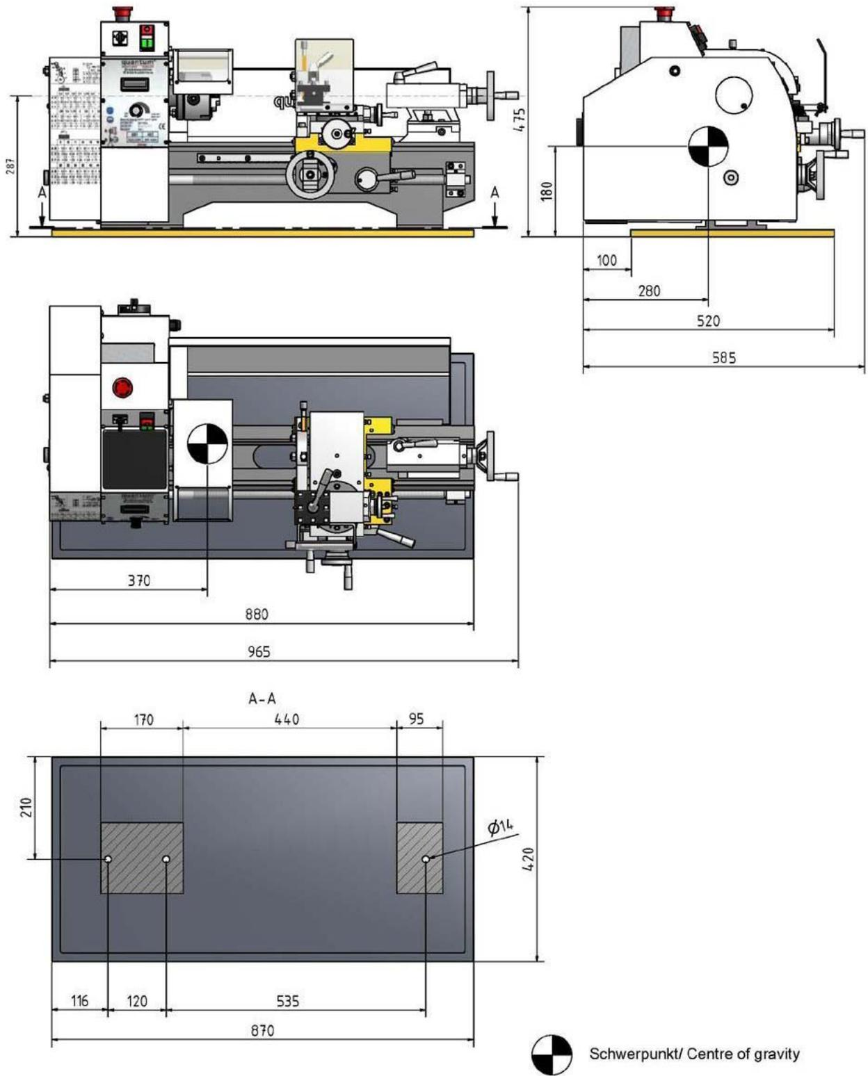
Abb.2-2: Abmessungen, Stellplan D210x400 Vario
