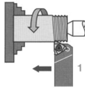
Abb.5-8: Klemmhalter zum Gewindedrehen
