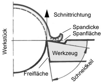
Abb.5-44: Geometrisch bestimmte Schneide beim Trennvorgang
