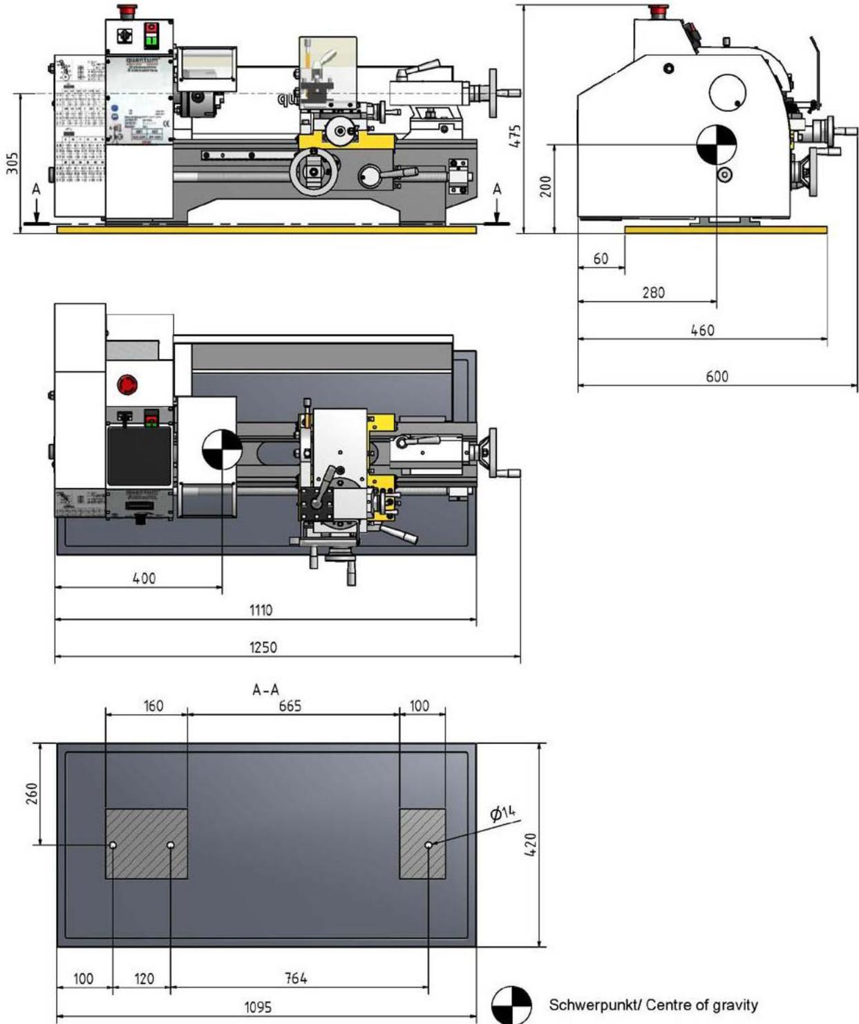
Abb.2-3: Abmessungen, Stellplan D250 x 550
