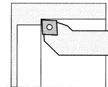
Abb.5-4: linke Bohrstange
