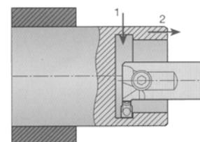
Abb.5-7: Bohrstangen zum Einstechdrehen
