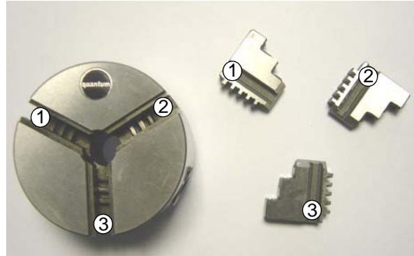
Abb.4-19: Dreibackenfutter / Spannbacken
