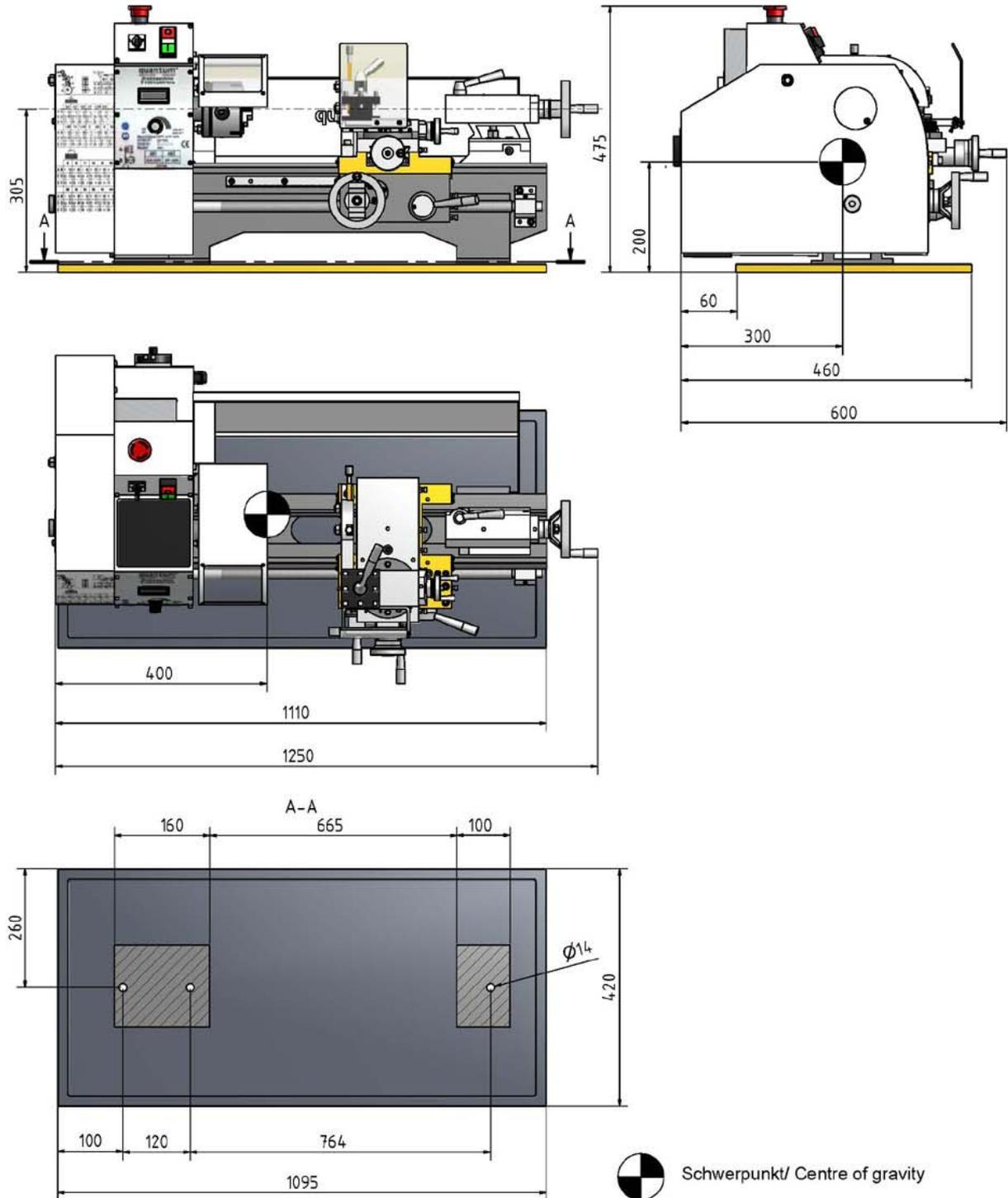
Abb.2-4: Abmessungen, Stellplan D250x550 Vario
