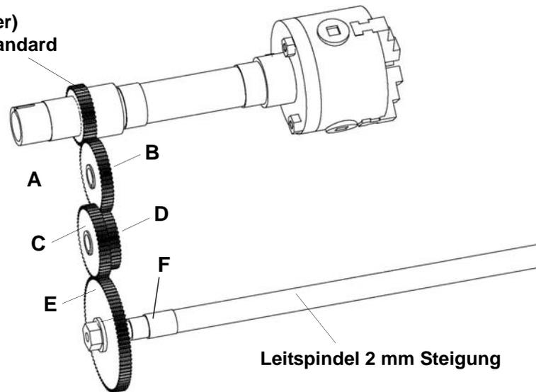
Abb.4-11: Aufbau Wechsellradgetriebe
