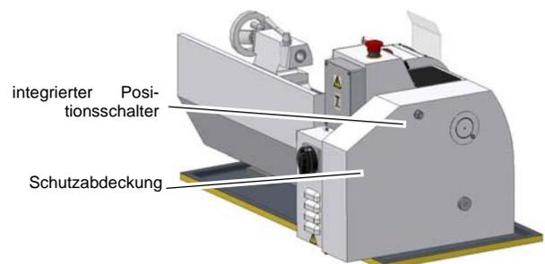
Abb. 1-3: Schutzabdeckung Spindelstock
