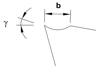
Abb. 5-49: Spanleitstufe mit Hohlkehle
