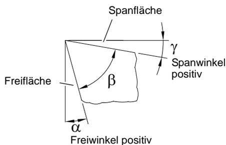
Abb.5-46: Schnitt A - A, positive Schneide
