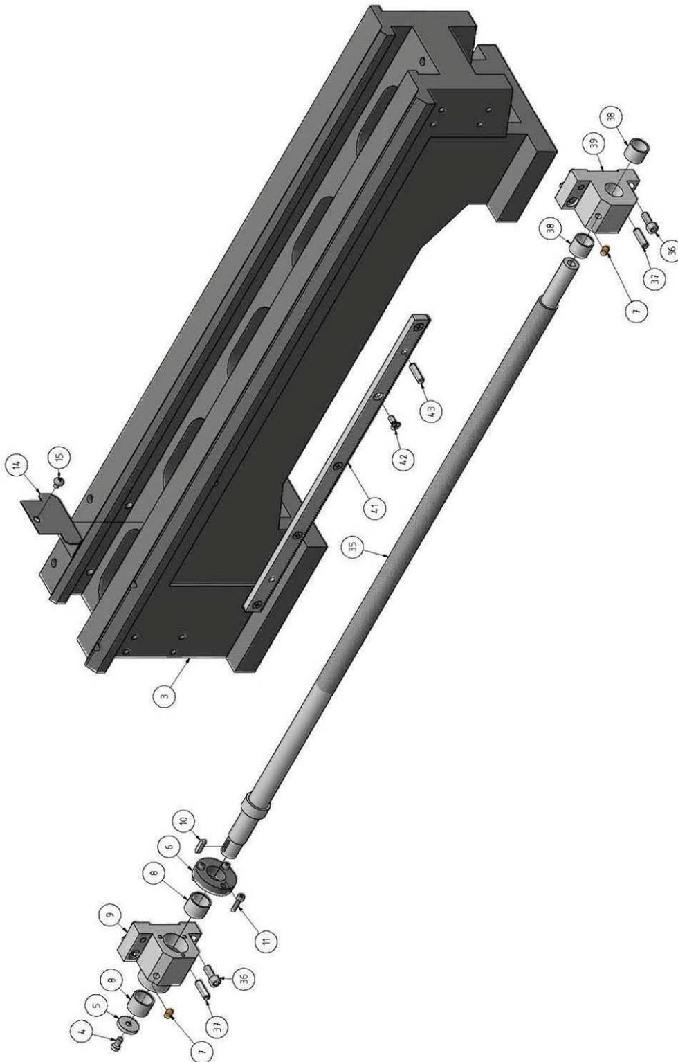
Abb. 8-9: Maschinenbett - Lathe bed
