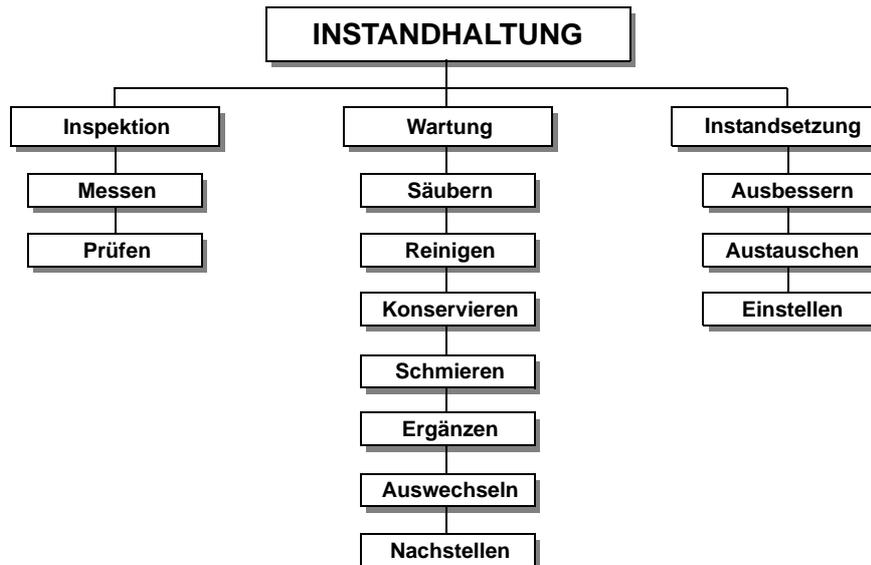
Abb.6-1: Instandhaltung – Definition nach DIN 31 051
