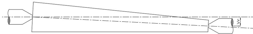
Abb.5-43: Werkstück zwischen Spitzen: Reitstockverstellung  $V_r$
