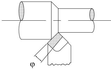
Abb.5-50: Positiver Öffnungswinkel zum Schlichten
