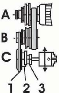
Abb. 4-8: Drehzahltable D 250 x 550
