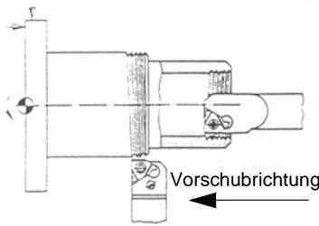
Abb.5-28: Rechtsgewinde bei Rechtslauf der Maschinenspindel
