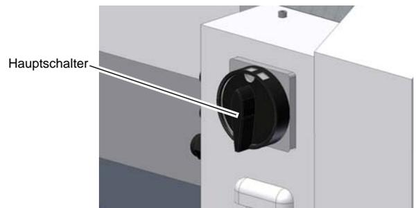
Abb. 1-2: Hauptschalter abschließbar
