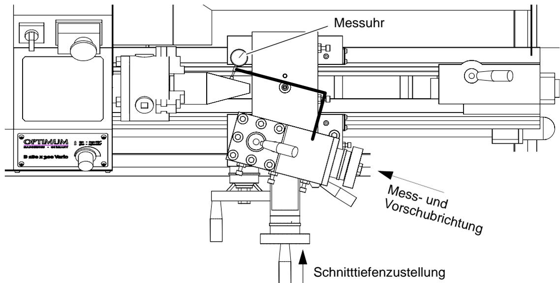
Abb.5-42: Kegelermittlung mit Messuhr
