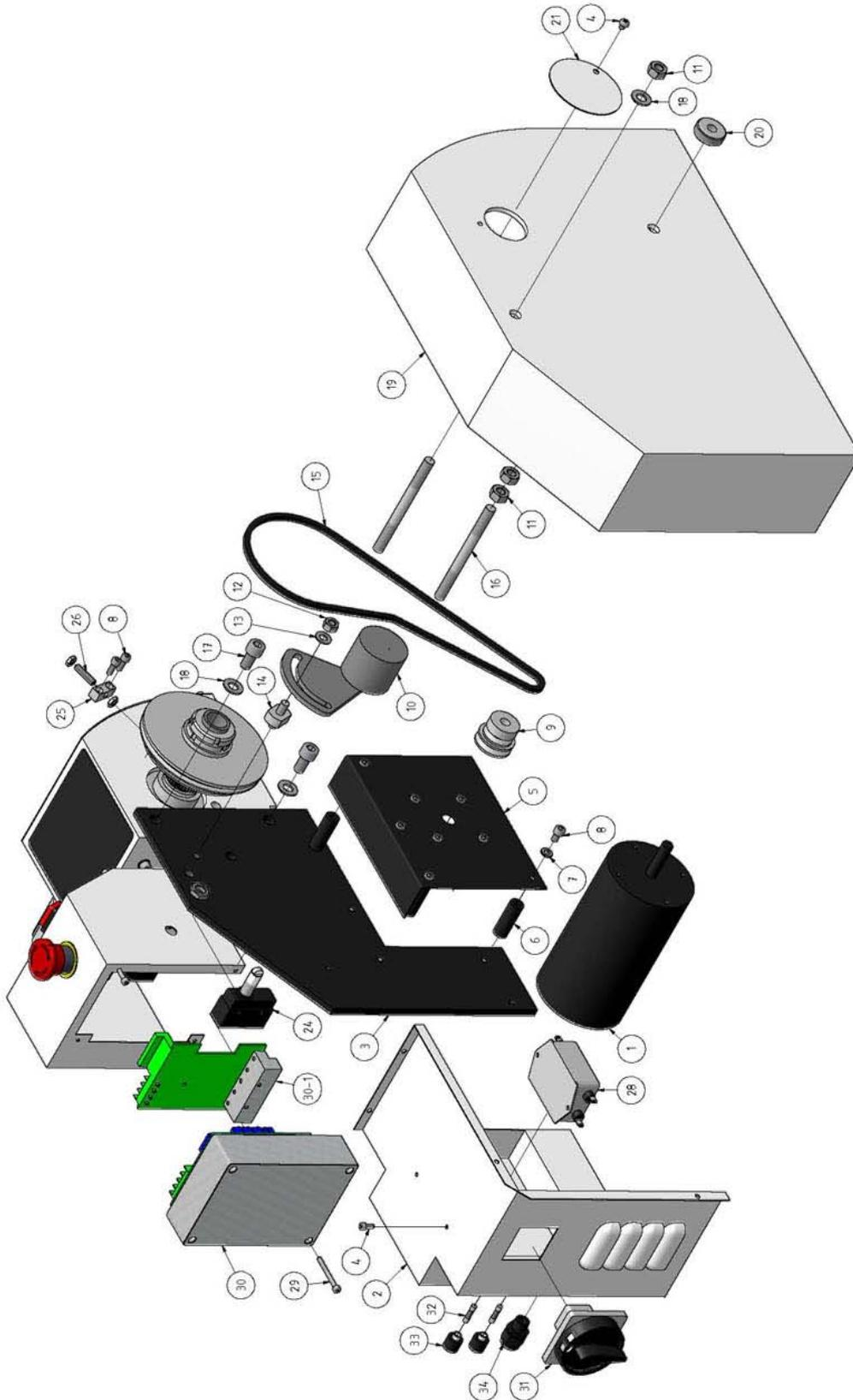
Abb.8-10: Vario Antrieb D210 - Vario drive D210
