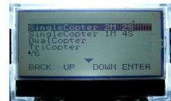
Springen Sie in das Menü „Show Motor Layout“ und überprüfen Sie: Stimmt die Konfiguration?
